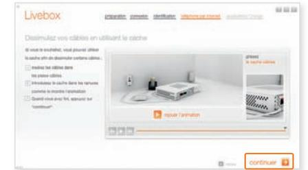
Il est possible de dissimuler certains des branchements de câble de la Livebox. Pour cela, utilisez le cache câble. Faites passer les câbles sur le côté de la Livebox dans les passe-câbles, puis insérer le cache câble dans sa rainure. Enfin, cliquez sur « **continuer** ».
