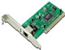
**La carte réseau Ethernet permet de connecter l'unité centrale sur un réseau local via un concentrateur de données (switches) pour accéder à d'autres machines connectées sur ce même réseau. (PC, imprimante réseau, routeur, etc..)**
