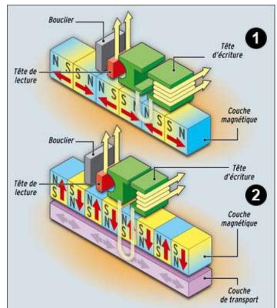
Avec la technologie LMR, la densité maximale est de 100 à 200 Go par pouce carré (un carré de 2,54 cm de côté) alors que la technologie PMR permet d'atteindre 1To (1000Go)/pouce carré.
