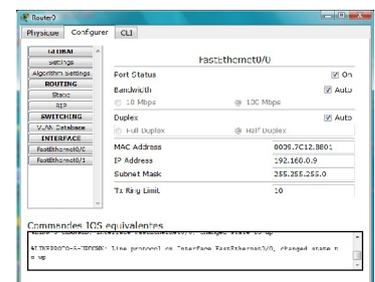
Recommencer la même opération avec une 2e IP qui correspondra à l'adresse réseau 172.16.0.0, affecter l'IP 172.16.0.9 par exemple (masque 255.255.0.0) sur le 2<sup>e</sup> port « FastEthernet » du routeur.
