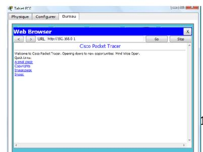
Cliquer sur la tablette PC (par exemple) pour ouvrir sa fenêtre de propriétés, onglet « bureau », ouvrir le « navigateur web », dans la zone URL taper l'adresse IP du serveur : <http://192.168.0.1> puis cliquer sur « GO »
