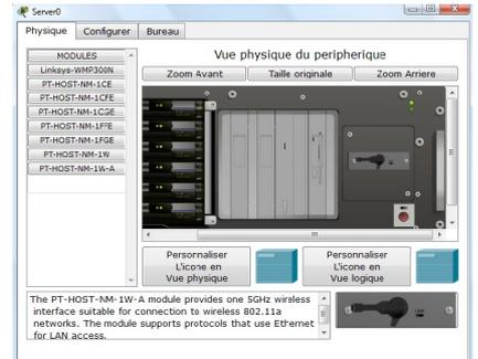
Nous allons maintenant lui donner une adresse IP fixe : choisir l'onglet « configurer » puis cliquer sur l'interface « Wireless », dans « IP configuration, cochez « Static » puis rentrer l'adresse IP 192.168.0.1 avec le masque de sous-réseau 255.255.255.0. Fermer la fenêtre.
