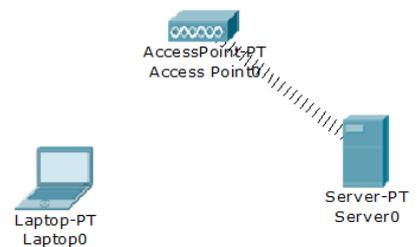
De la même façon, configurer l'ordinateur portable en remplaçant le connecteur. Laissez (ou mettez) sa configuration IP en mode DHCP.
