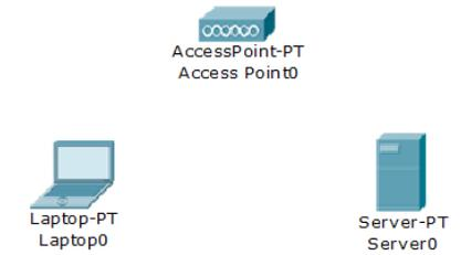
Aucun des terminaux ne peut se connecter au point d'accès car il n'ont pas de connexions WIFI : cliquer sur le serveur pour ouvrir sa fenêtre de propriétés, onglet « physique », sur la face arrière visible, éteindre le serveur et remplacer le connecteur Fast Ethernet (PT-HOST-NM-1CFE) par un connecteur wireless (PT-HOST-NM-1W). Rallumer le serveur.
