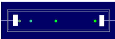
2) Entre les électrodes, les électrons subissent une accélération et acquièrent de l'énergie.
