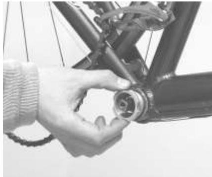
Figure 5 : Montage du capteur Ergomo dans le pédalier
