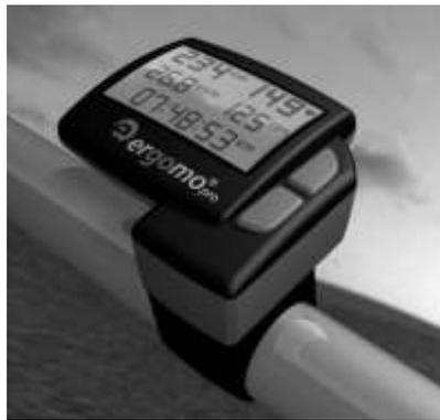
Figure 5 : L'ordinateur de bord Ergomo placé sur le guidon.
