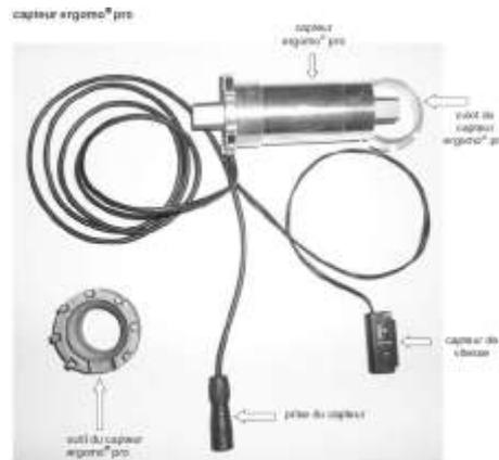
Figure 4 : Le capteur Ergomo pro et ses accessoires.
