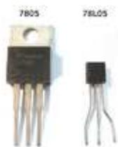
Un **régulateur de tension**, est un organe électrotechnique ou un composant électronique qui maintient, dans certaines limites, à sa sortie une tension constante, indépendamment, de la charge et de la tension d'entrée.
