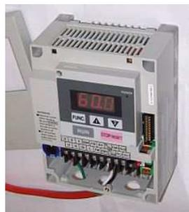
Dans un moteur à courant alternatif, la vitesse mécanique du rotor est liée à la fréquence des courants au stator. Ce lien mathématique rend possible une commande de la vitesse du rotor par la commande de la fréquence du courant au stator. C'est ce que l'on appelle la condition de synchronisme qui s'exprime différemment selon que l'on considère une machine synchrone ou une machine asynchrone.
