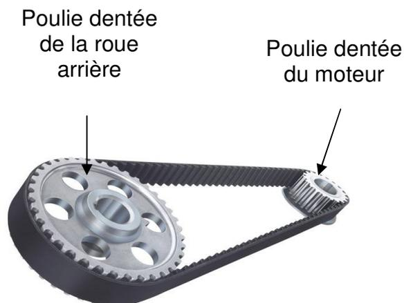
La puissance mécanique transmise entre la poulie Moteur et la poulie de la roue arrière est identique. Cependant la vitesse angulaire et le couple du moteur et de la roue arrière varient en fonction du rapport de transmission.
