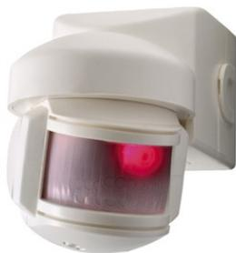
Un détecteur infrarouge « I.R. » passif analyse le rayonnement thermique émis par tout mammifère. Tout corps vivant émet donc un rayonnement infrarouge. La fonction du détecteur est détecter toute rayonnement de chaleur et d'émettre une information si ce rayonnement est en mouvement (le capteur doit faire la différence entre un radiateur électrique qui se met en route et le passage d'un homme).
