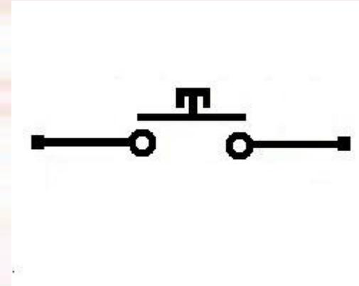
Ce composant parfois appelé « BP » ferme un circuit électrique si on appuie dessus avec le doigt. Il est utilisé par exemple pour les sonnettes.
