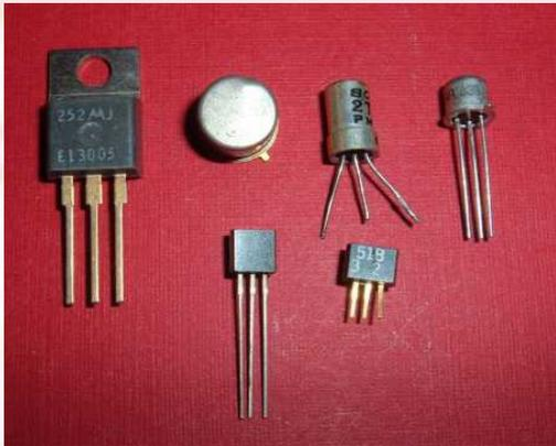
Composant de base en électronique , il est composé de 3 broches. Il existe 2 types de transistors: le type NPN et le type PNP
