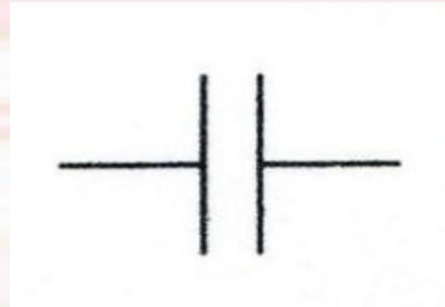
Ce composant est constitué de deux surfaces conductrices (armatures) séparées par un isolant. Son symbole est constitué de deux segments parallèles à deux à trois millimètres de distance.
