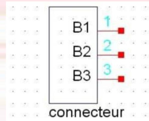
Prise permettant la connexion électrique entre 2 (ou plus) fils conducteurs d'électricité. Cette connexion est démontable mécaniquement.
